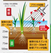
※苗に接触時はワイヤーのバネ機能を活かし逃げる ・強い水流により土を攪拌除草しやすくする(攪拌水流機能)
